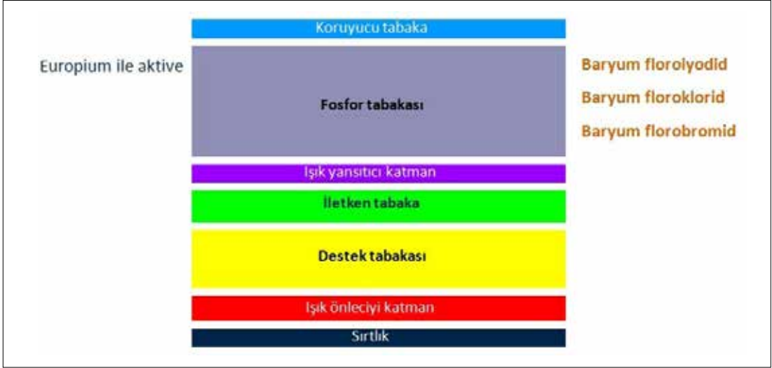
Resim 3. Depo fosfor plakasının kesitsel yapısının şematik görünümü.
